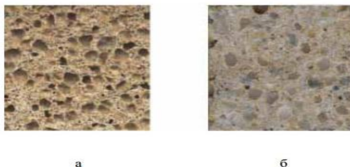
Рис.1. Включение ТАМ (парафина) в стеновую панель: а – материал без ТАМ; б – поры материала заполнены ТАМ
